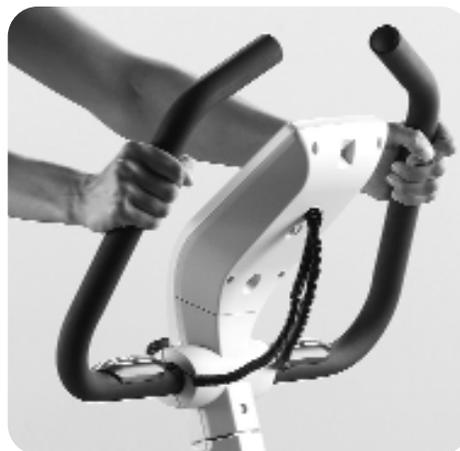
Le guidon de votre vélo d'appartement est réglable dans son inclinaison. Desserrez la vis en dessous du cockpit et réglez la position optimale pour vous. Resserrez bien la vis ensuite de manière à ce que le guidon ne glisse pas !
